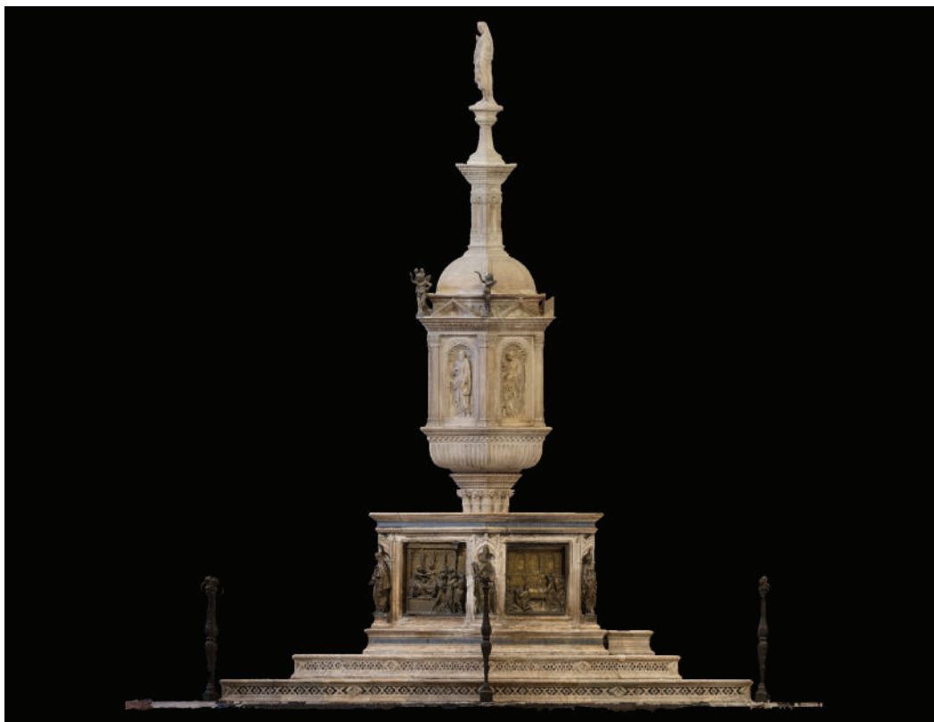
Proiezione ortografica del modello 3D a bassa risoluzione geometrica, ottenuta mediante fotogrammetria (foto da droni e reflex digitale). Mattia Mercante
