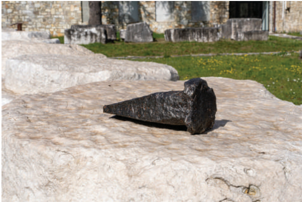
Cuneo in ferro rinvenuto nell'area delle cave. Età romana. Museo Civico del Marmo di Carrara. Foto Giuseppe D'Aleo. Immagine concessa dal Ministero della Cultura – Soprintendenza ABAP per le province di Lucca e Massa Carrara
